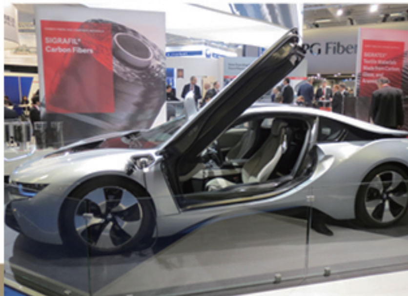
上图为宝马 i8 跑车，车体采用德国 SGL 集团碳纤维复合材料制造
