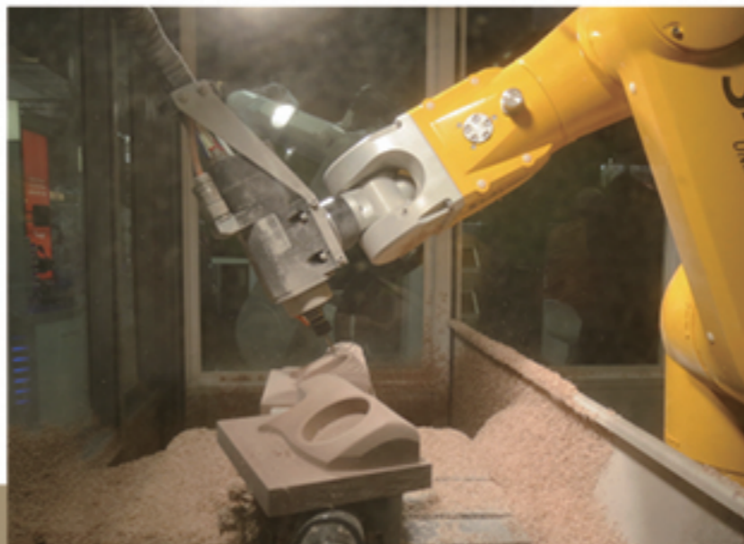
上图为美国 Staubli Robotics 公司的高速机械手臂正在对复合材料进行精确研磨加工
